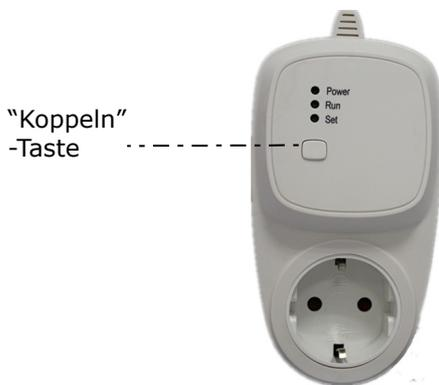
Das Thermostat und der Empfänger haben beide einen Binärcode durch den beide Geräte gekoppelt werden können. Ab Werk sind die beiden Geräte bereits gekoppelt. Bitte verfahren Sie, wie in den folgenden Schritten beschrieben, für den Fall, dass die Geräte nicht gekoppelt sein sollten.
